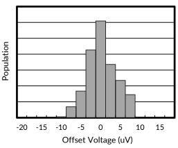
Figure 1. Offset Voltage Production Distribution
